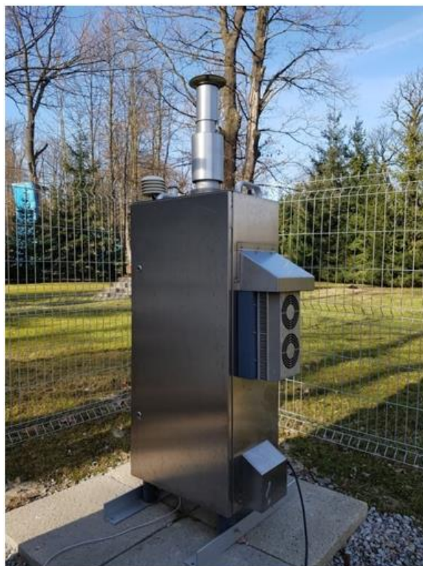
Fot.1. Pobornik pyłowy zainstalowany w punkcie pomiarowym
