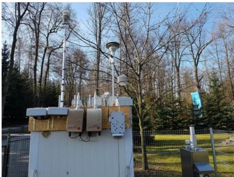
Fot.2. Lokalizacja czujników do pomiaru pyłu zawieszonego PM10 w obrębie stacji pomiarowej
